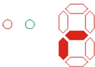
После отпускания кнопки брелок отобразит текущую версию прошивки. Пример для версии 1.05:
