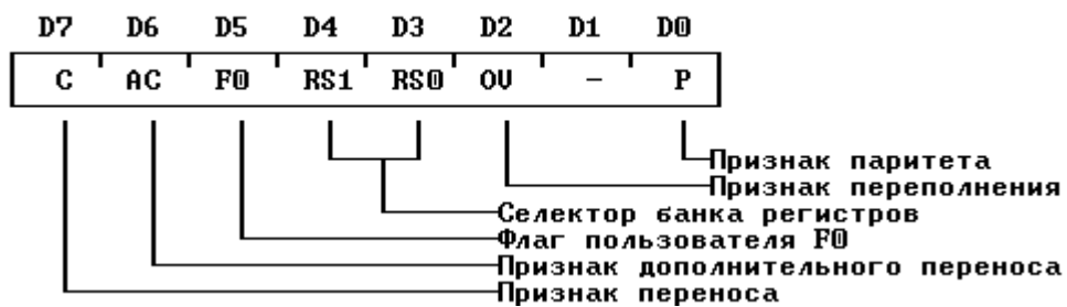
Рисунок 5.8. Формат слова-состояния ОМЭВМ семейства 051.
