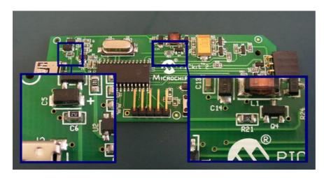
Резистор R34 (2.7КОм, размер 0603) удобно припаять параллельно конденсатору С6.
