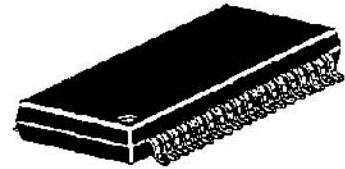
Outline 42P2R-A 0.8mm pitch 450mil ssop (8.4mm×17.5mm×2.0mm)
