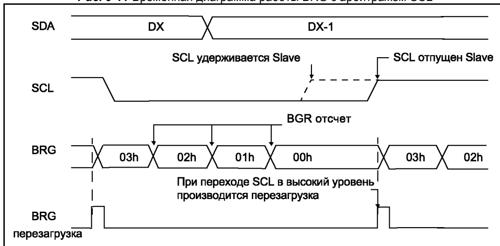
Рис. 9-11 Временная диаграмма работы BRG с арбитражем SCL
