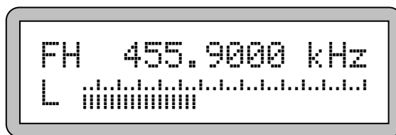
Рис. 19. Индикация максимальной частоты 455.9 кГц.
