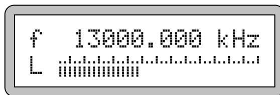
Рис. 13. Индикация значения 13 МГц с учетом промежуточной частоты.
