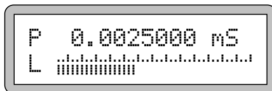
Рис. 14. Индикация значения периода 2.5 мкс.
