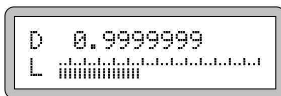
Рис. 17. Индикация коэффициента заполнения 0.9999999.
