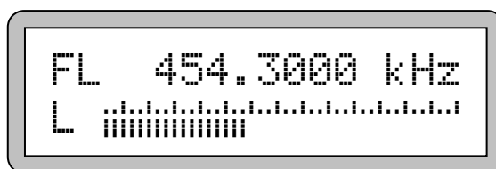
Рис. 20. Индикация максимальной частоты 454.3 кГц.
