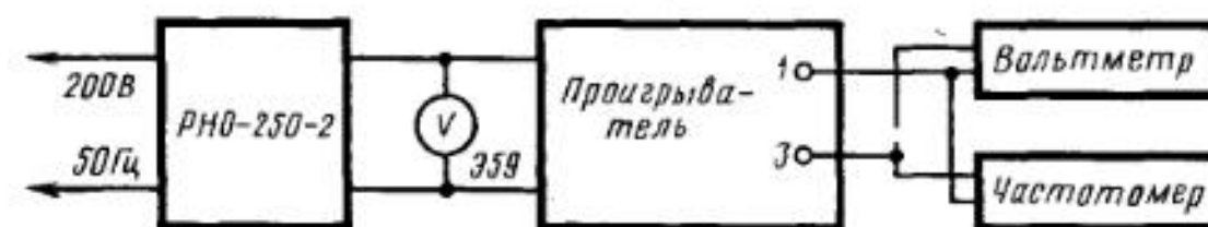
Рис. 24. Блок-схема рабочего места для настройки проигрывателя: 1, 3 — выводы основной обмотки двигателя
