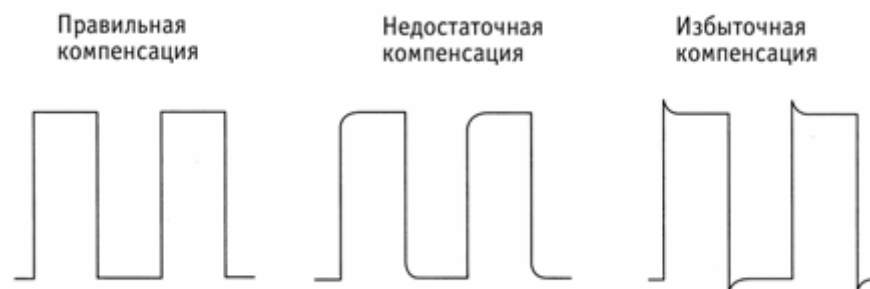
(б) ВЛИЯНИЕ КОМПЕНСАЦИИ ПРОБНИКА НА ИЗОБРАЖЕНИЕ СИГНАЛА МЕАНДРА
