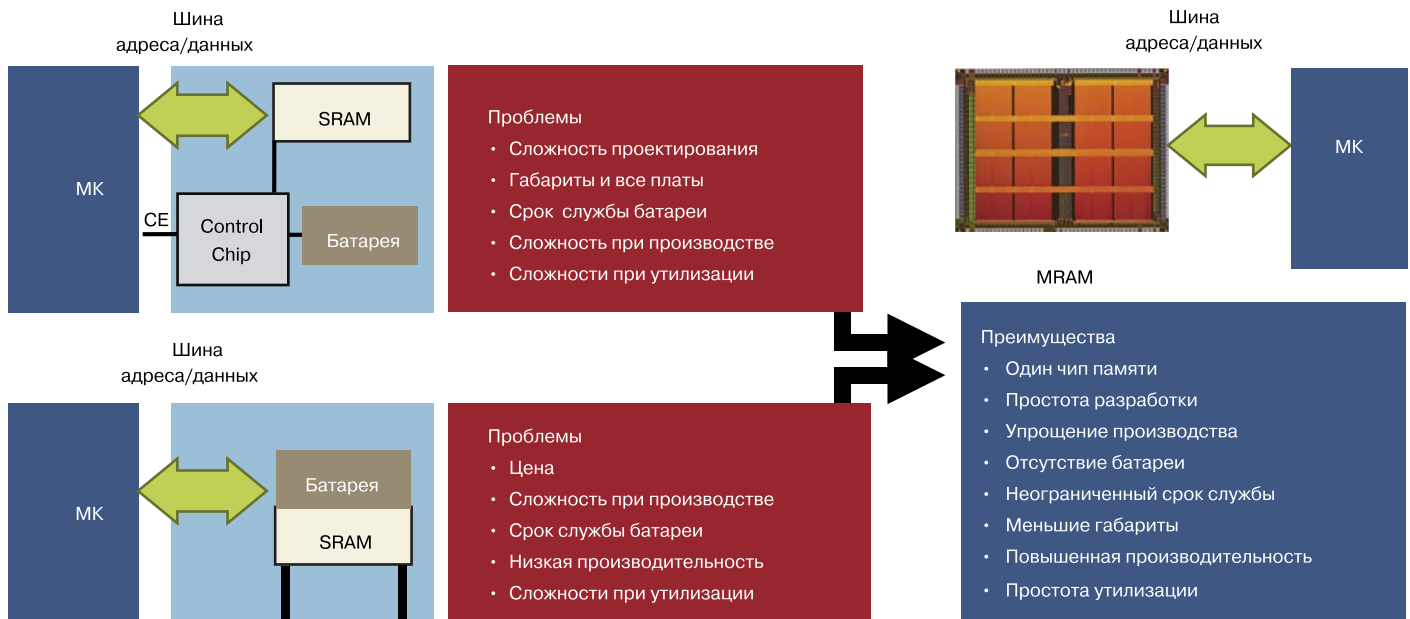
Рис. 4. MRAM в качестве альтернативы памяти Battery Backed SRAM
