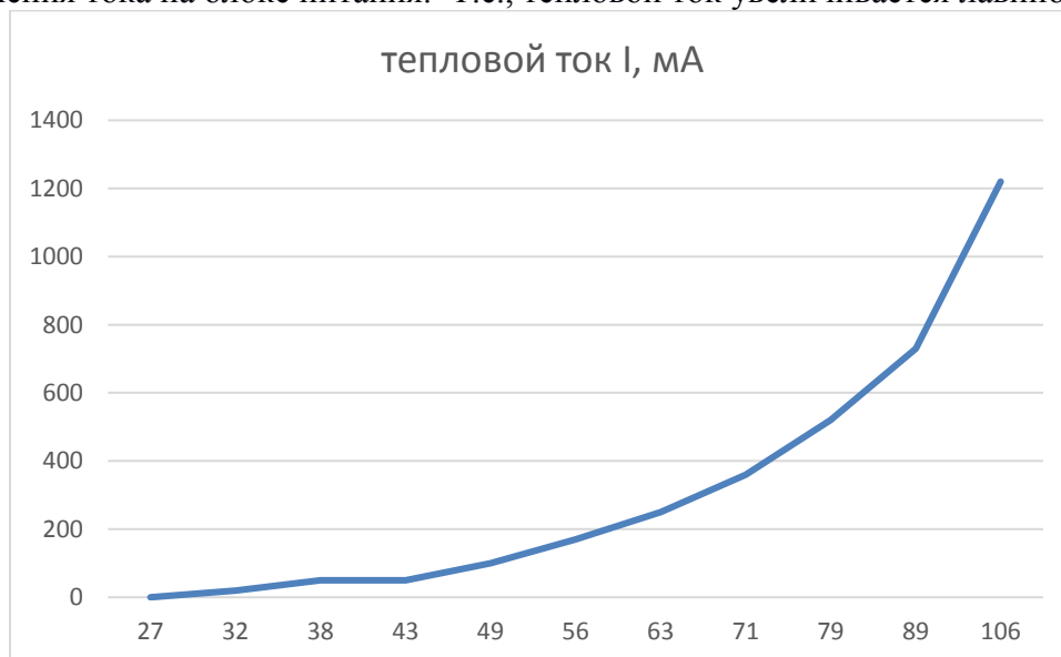
Рисунок 6. Увеличение тока выходных транзисторов в зависимости от температуры
