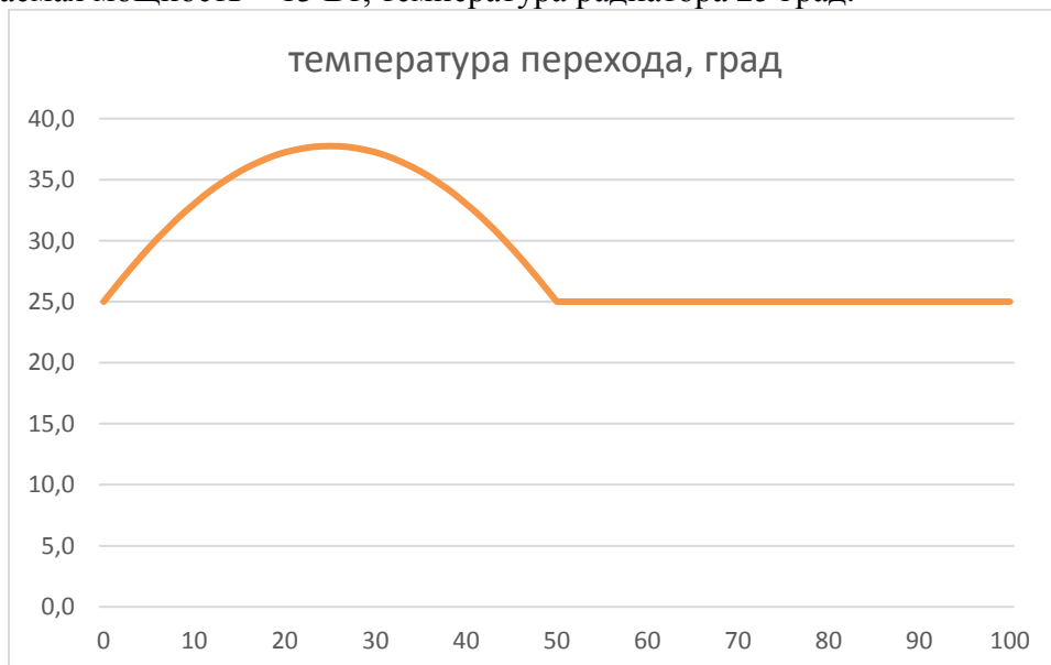
Рисунок 7. Температура перехода при амплитуде выходного напряжения 3 В
