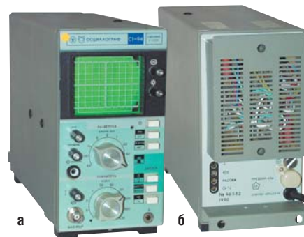
Рис. 1. Осциллограф С1-94 (а — вид спереди, б — вид сзади)
