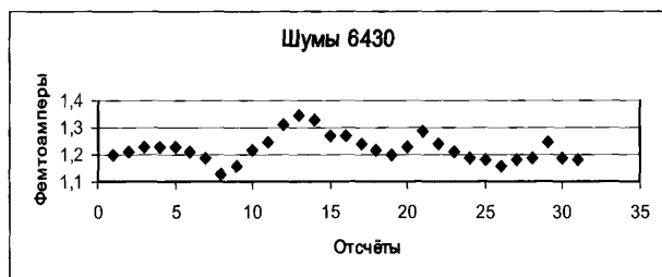
Рис. 5. Токовые шумы прибора 6430
