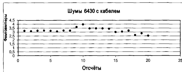
Рис. 7. Токовые шумы электрометра 6430 при соединении кабеля с калибратором НК4-1
