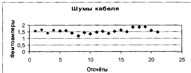
Рис. 6. Токовые шумы кабеля 6430 – 322 – 1А
