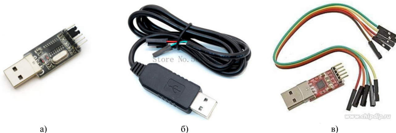
Рис. 13 Базовые проекты USB-UART интерфейса
