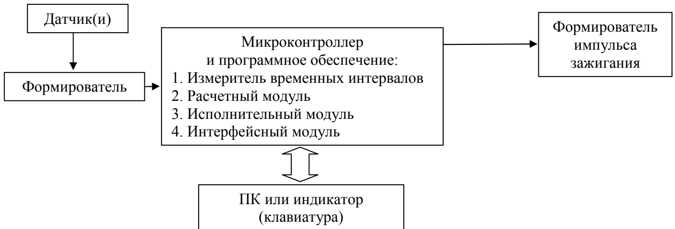
Рис.1 Блок схема ФУОЗ
