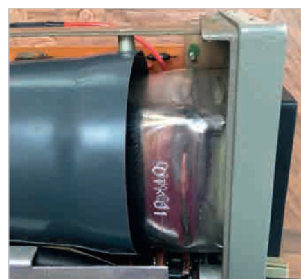
Рис. 6. Крепление раструба пермаллового экрана
