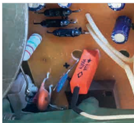
Рис. 2. Монтаж элементов D5, C7, R8
