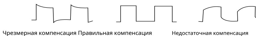
Рисунок 4-2 Компенсационная калибровка зонда
