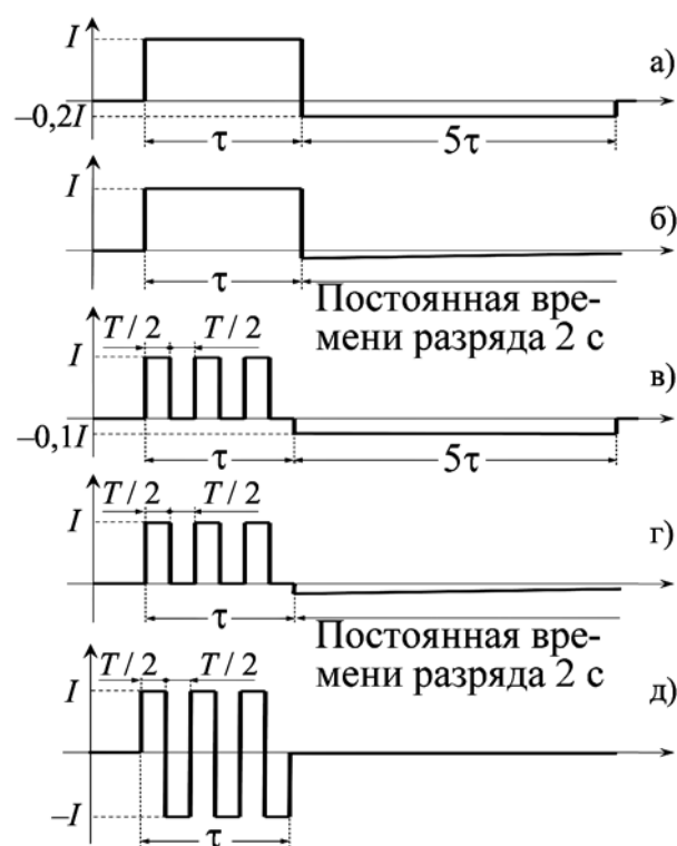
Рис. 2. Различные формы импульсов и деполяризующей фазы тока: а), б) прямоугольный немодулированный; в), г) прямоугольный модулированный однополярный; д) прямоугольный модулированный биполярный; а), в) активная деполяризующая фаза тока; б), г) пассивная деполяризующая фаза тока
