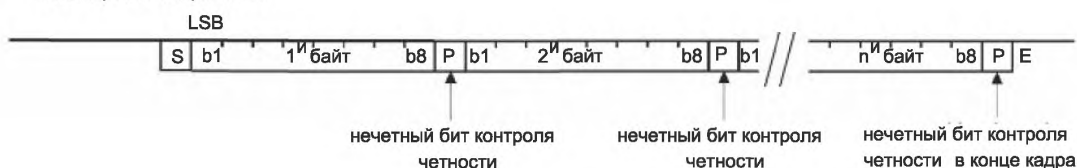
Рисунок 3 – Стандартный кадр PCD при скоростях передачи fc/128 , fc/64 , fc/32 и fc/16
