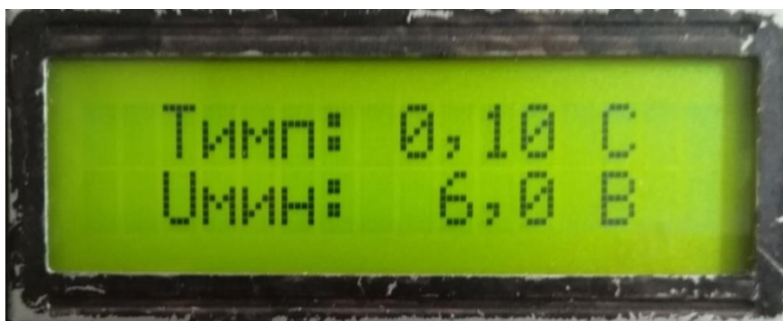
Рис.3. Режим 3,4 – задание Тимп, U_z от залипания электрода
