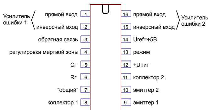
Рис. 11. Управляющая микросхема TL494 и ее цоколевка.
